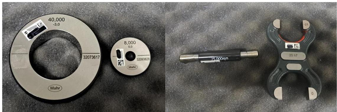
Abbildung 2: Kalibriergegenstände von links nach rechts: 1) Einstellringe, 2) Einstellmaß für Bügelmessschieber und Grenzrachenlehre
